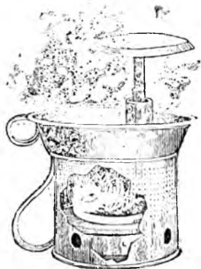
Рис. 254. Спиртовой аппаратъ для тонки и производства пара при „Транспиръ“.
